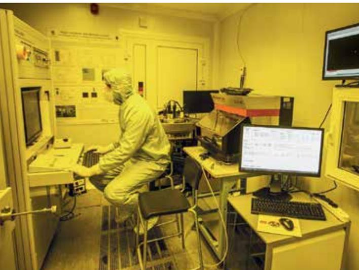
*Во второй чистой комнате располагаются устройства для литографии — универсальной технологии получения изображения элементов в микро- и наномасштабе, применяемой при изготовлении полупроводниковых приборов, интегральных микросхем и широкого спектра наноструктур. Слева — оператор, работающий за электронным литографом. Справа по центру — оптический (лазерный) литограф*
