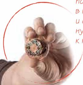
Держатель образца помещается в криостат и обеспечивает подвод нужных сигналов к квантовой схеме
