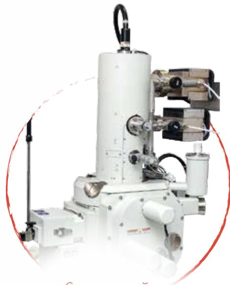
Сканирующий электронный микроскоп «ощупывает» пучком электронов (1 нм в диаметре) схему и выводит ее изображение на экран монитора
