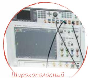
Широкополосный осциллограф контролирует быстротекущие процессы
