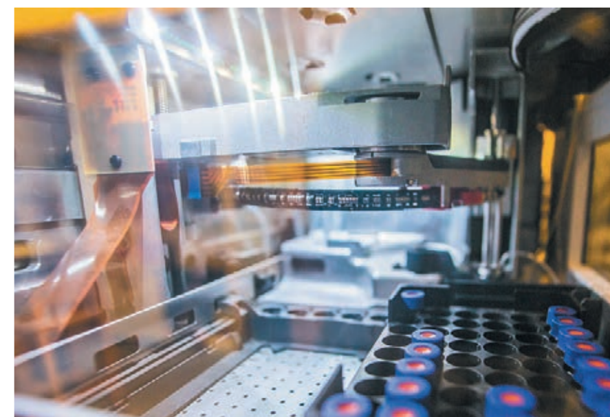
Автосэмплер для высокоэффективного жидкостного хроматографа
