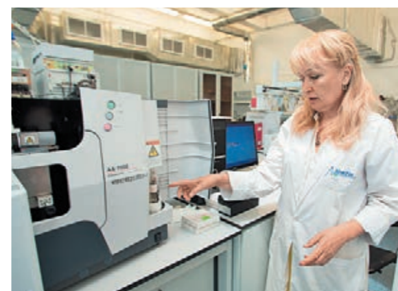
Заказы на исследования активно размещают продуктовые сети. На фото лаборант Вера Кокорева готовит образцы колбасы для экстракции в химикоаналитической части, после чего будет проведен анализ на наличие или отсутствие в продукте глутамата натрия (усилителя вкуса). Глутамат натрия очень хорошо растворим в воде, поэтому процедура расщепления перед дальнейшим экспериментом занимает около 10 минут.
