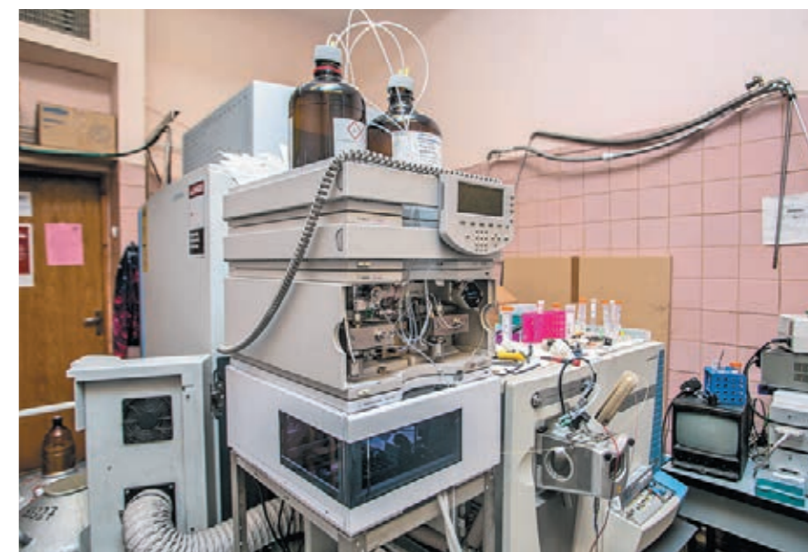
Масс-спектрометр ионного циклотронного резонанса с жидкостным хроматографом и наноспрейным источником ионов
