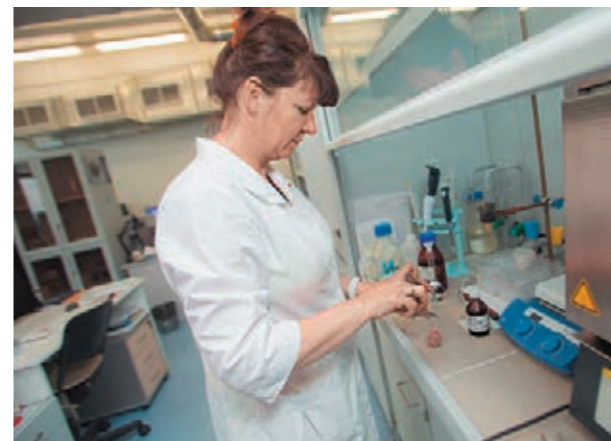
Заказы на исследования активно размещают продуктовые сети. На фото лаборант Вера Кокорева готовит образцы колбасы для экстракции в химикоаналитической части, после чего будет проведен анализ на наличие или отсутствие в продукте глутамата натрия (усилителя вкуса). Глутамат натрия очень хорошо растворим в воде, поэтому процедура расщепления перед дальнейшим экспериментом занимает около 10 минут.
