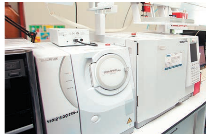
Газовый хромато-масс-спектрометр с дополнительным плазменно-ионизационным детектором и автоинжектором ввода жидких проб и равновесной паровой фазы используется для определения наличия органических растворителей в фармацевтических субстанциях или в других пробах. Этот прибор также выполняет функции масс-спектрометра. Метод газовой хроматографии широко используется для определения состава почв. Легко обнаруживает такие соединения, как нефтяные и битумные загрязнения.
