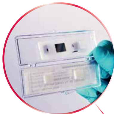
Биосенсорный чип с графеновой поверхностью. Расширяет области применения безмаркерных биосенсоров.
