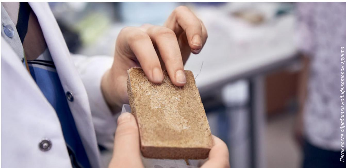
Песок после обработки модификатором грунта
