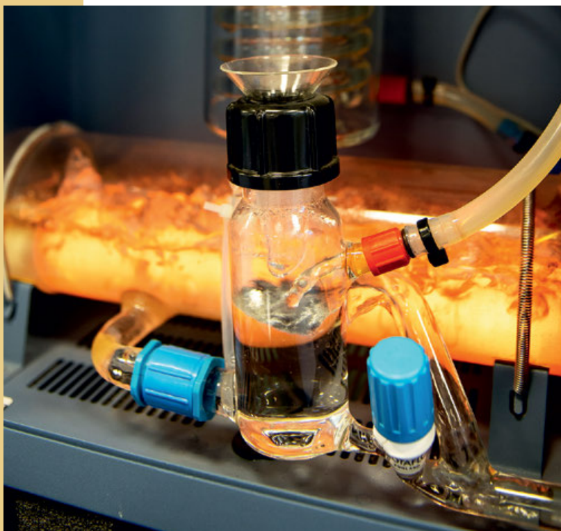
Дистиллятор Aquatron A 4000. На фото: процесс получения апиогенного дистиллята высокой степени очистки с низкой температурой на выходе из исходной воды практически любого качества
