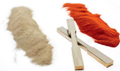
Напечатанный брусок на фоне порошков титана и меди
