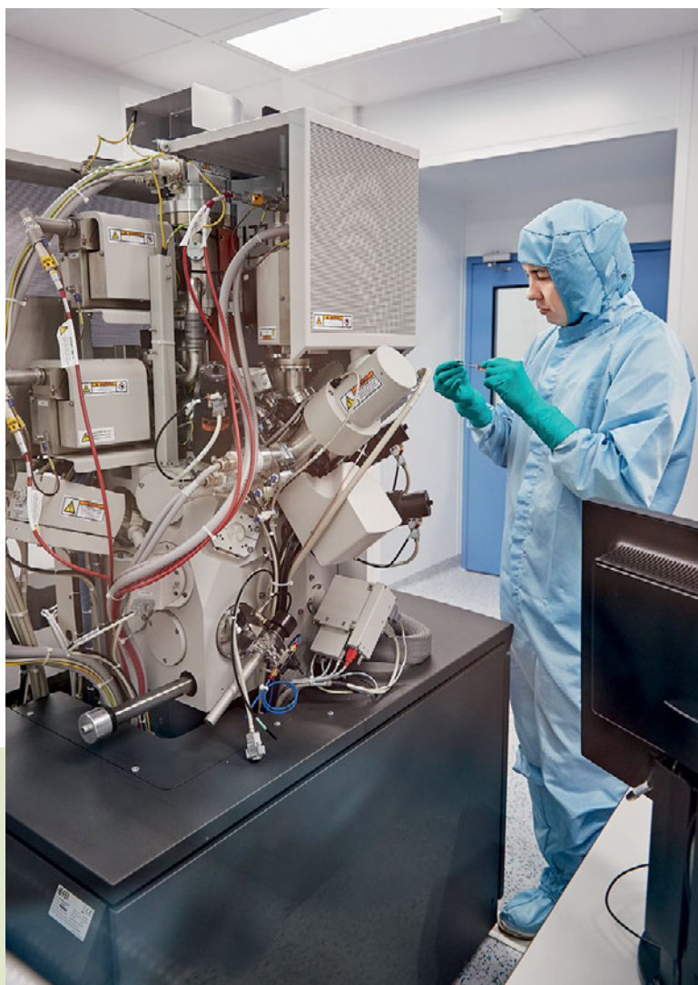
Электронно-ионный двухлучевой микроскоп. Инженер Бурхан Массалимов производит загрузку образца для его обработки с разрешением 2 нм фокусированным пучком ионов Ga
