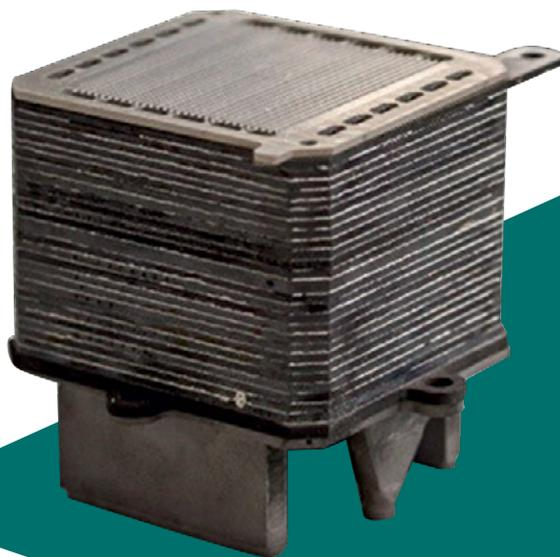
*Собранная из блоков ТОТЭ батарея. Фото из лаборатории топливных элементов МФТИ*
