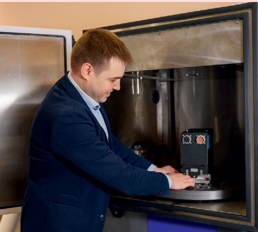
Испытания нового датчика — как раз следующий пункт в чек-листе ученых. В декабре лаборатория получила от Физтеха высокоточный имитатор движения. Этот стенд калибрует ошибки во вращении гироскопов, запоминает их реальные, а не идеальные теоретические характеристики. В результате система обучается разным условиям эксплуатации.
