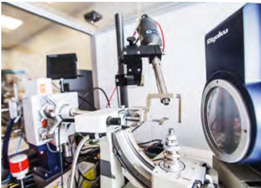
Установка Rigaku для рентгеновской кристаллографии белков
