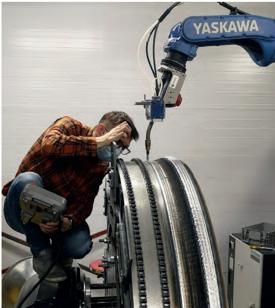
Инженер-технолог Арсений Кисарев контролирует процесс 3D-печати конструкции днища топливного бака
