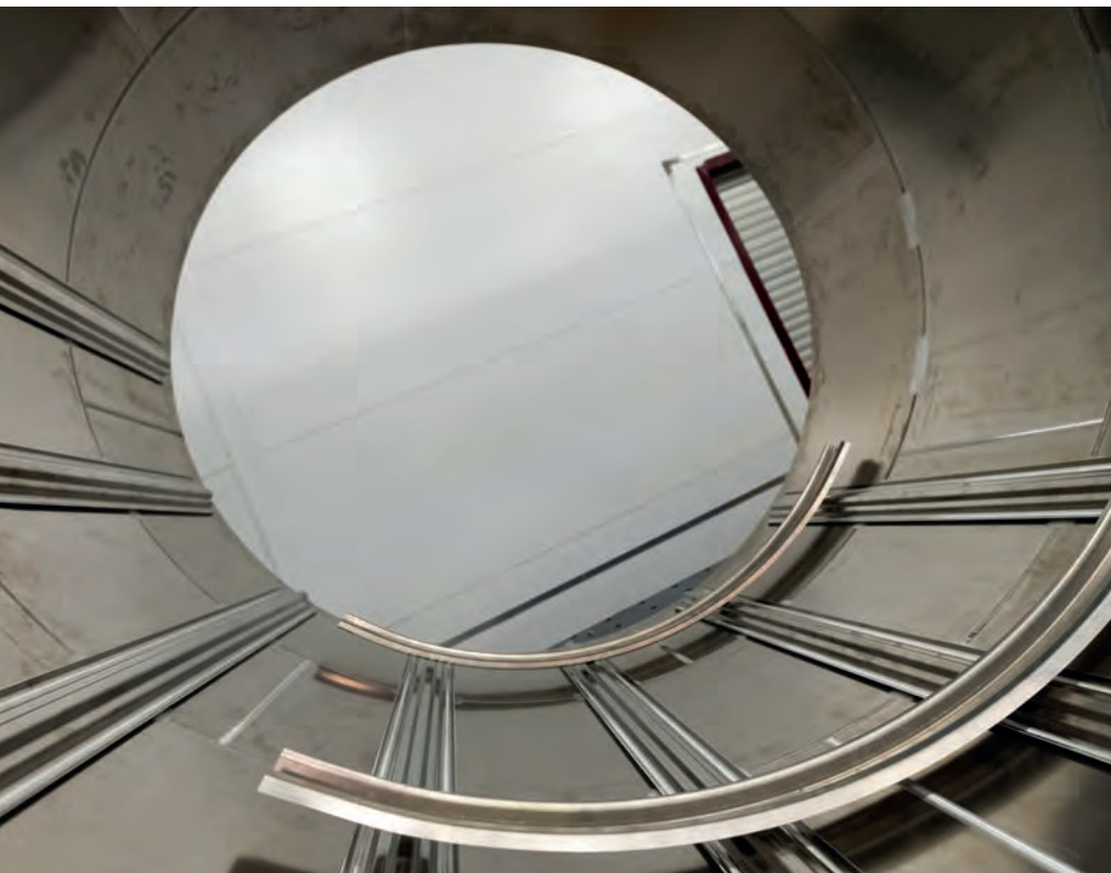
Прототип разработанного стрингерно-шпангоутного подкрепления обечайки ракеты
